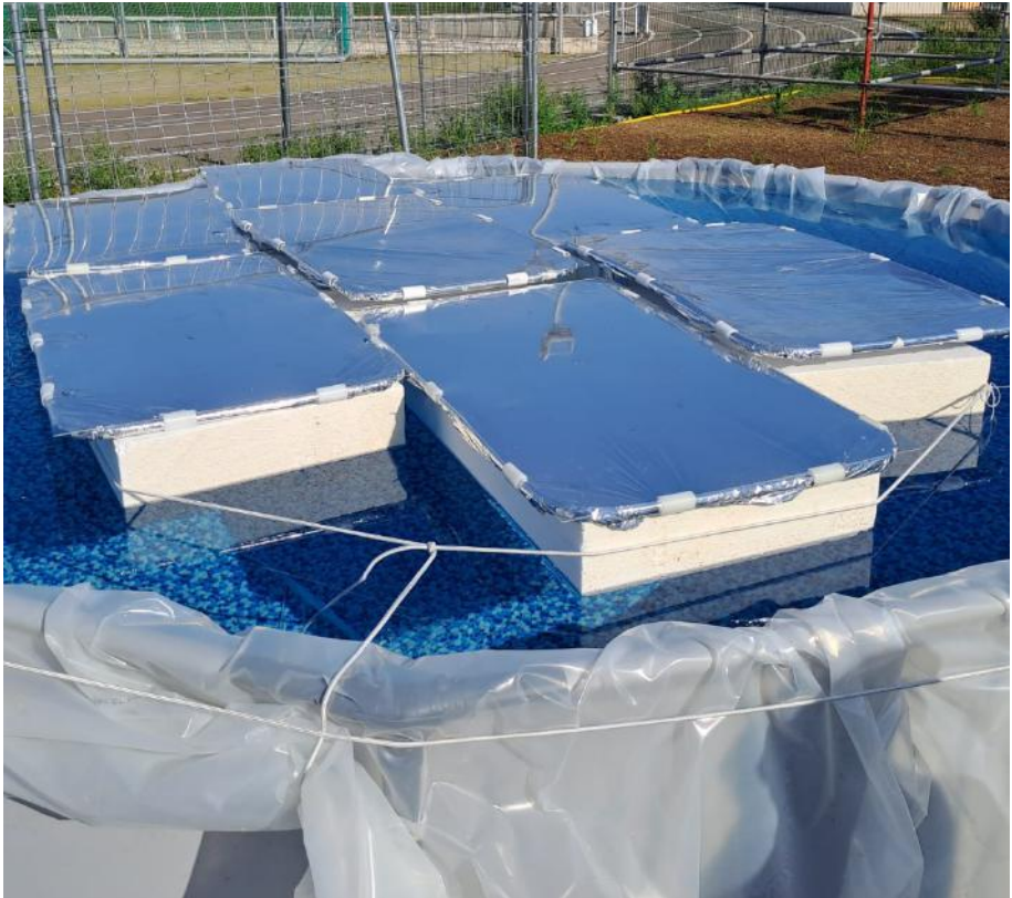
Unidad de módulos reflectantes en tanque de agua.
